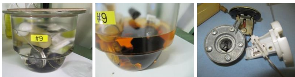
Illustration 6: Examen du capteur de réservoir de carburant, de la pompe à essence et du carburateur en immersion (à gauche et au milieu) ainsi qu'à la fin de l'étude
