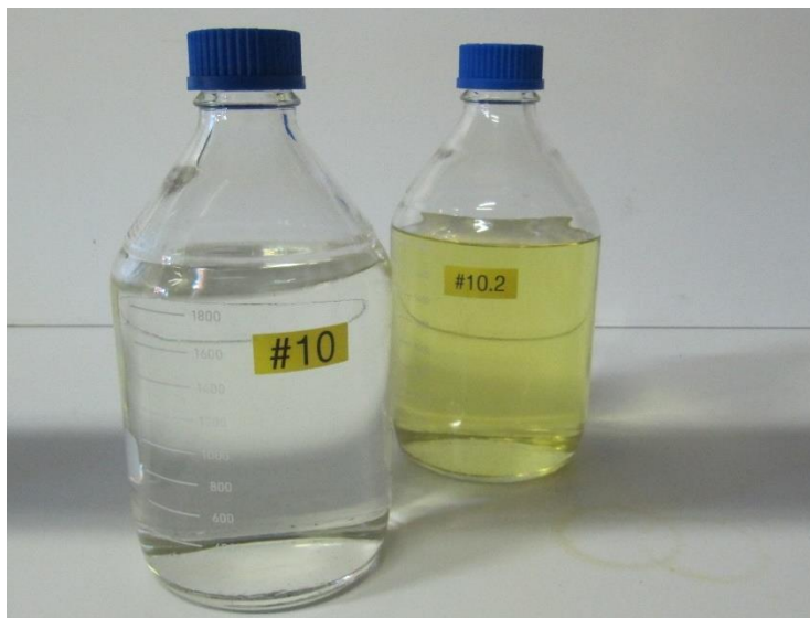
Illustration 1: Échantillons d'essence biosynthétique claire (à gauche) et d'essence fossile jaunâtre (à droite)
