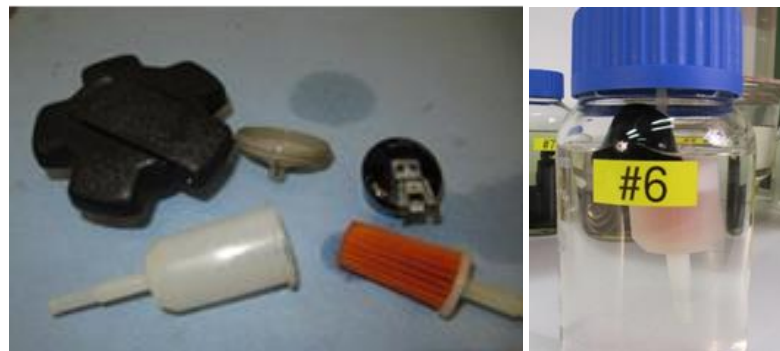
Illustration 4: Pièces en plastique testées du point de vue de la compatibilité avec le carburant
