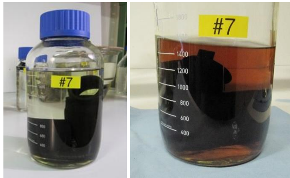
Illustration 5: Échantillons de tuyaux sans (à gauche) et avec décoloration de l'essence biosynthétique (à droite)
