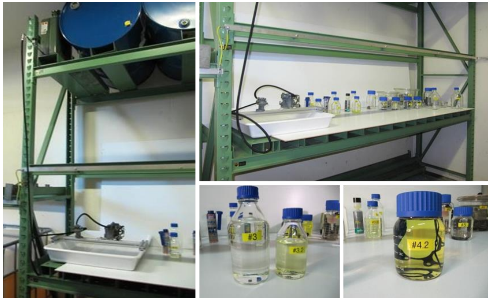
Illustration 3: Dispositif expérimental pour les études de compatibilité avec les matériaux (le flacon #3 contient de l'essence biosynthétique et les flacons #3.2 et #4.2 de l'essence fossile)
