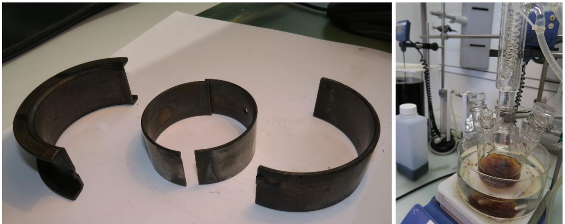
Illustration 20: Coques de palier contenant du plomb (à gauche) et dispositif expérimental (à droite) pour analyser l'attaque d'un mélange de 10% de MTBE et 90% de TOPAZ SAE 20W-50 à 80 °C
