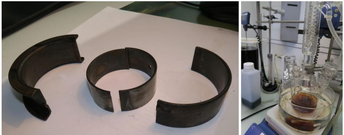
Abbildung 20: Bleihaltige Lagerschalen (links) und Versuchsaufbau (rechts) zur Untersuchung des Angriffs durch ein Gemisch von 10% MTBE und 90% TOPAZ SAE 20W-50 bei 80°C
