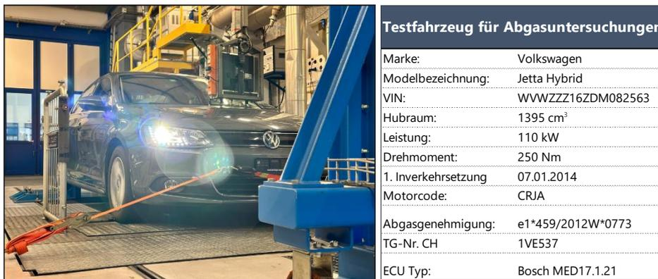
Abbildung 8: Testfahrzeug für Abgasuntersuchungen
