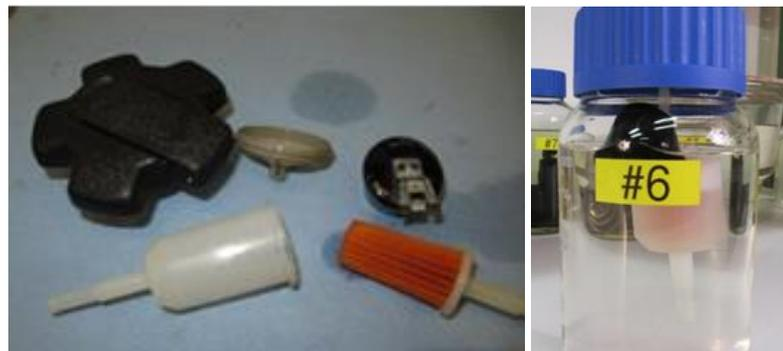
Abbildung 4: Hinsichtlich Treibstoffverträglichkeit untersuchte Kunststoffteile
