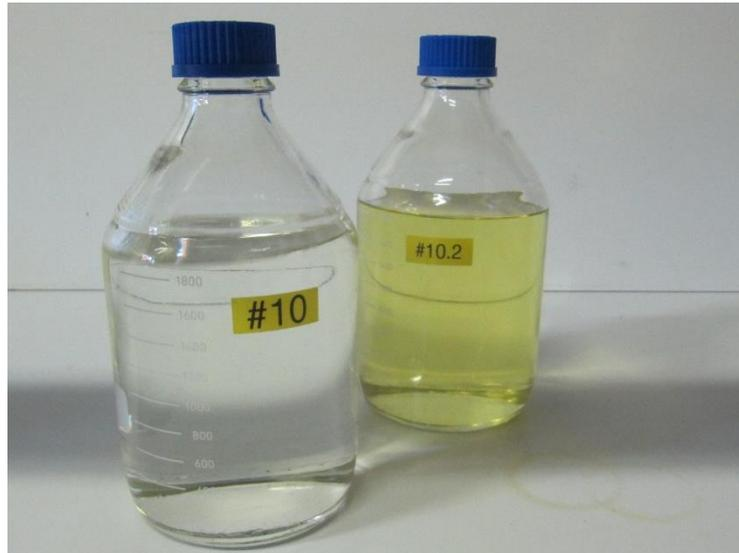
Abbildung 1: Proben des klaren biosynthetischen Benzins (links) und des gelblichen fossilen Benzins (rechts)
